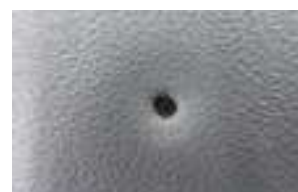
塩ビシート仕様：落下高さ1.0mで1体でも穴があく(区分2)⇒
